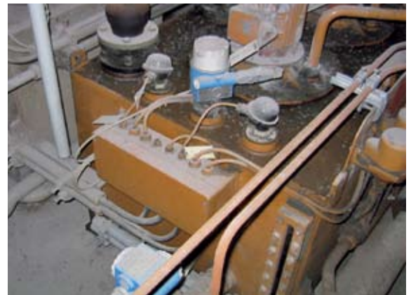
Medición de nivel en un tanque del aceite hidráulico
