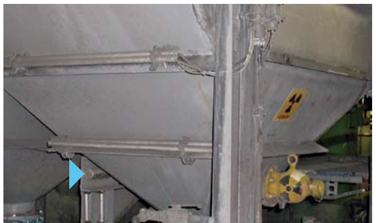
Gammapiilot para la detección de límite máximo en el filtro electrostático
