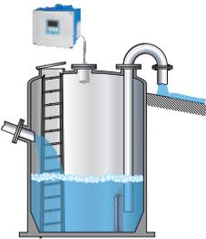
Pozo con bomba / construcción con aliviadero / depósito de aguas pluviales
